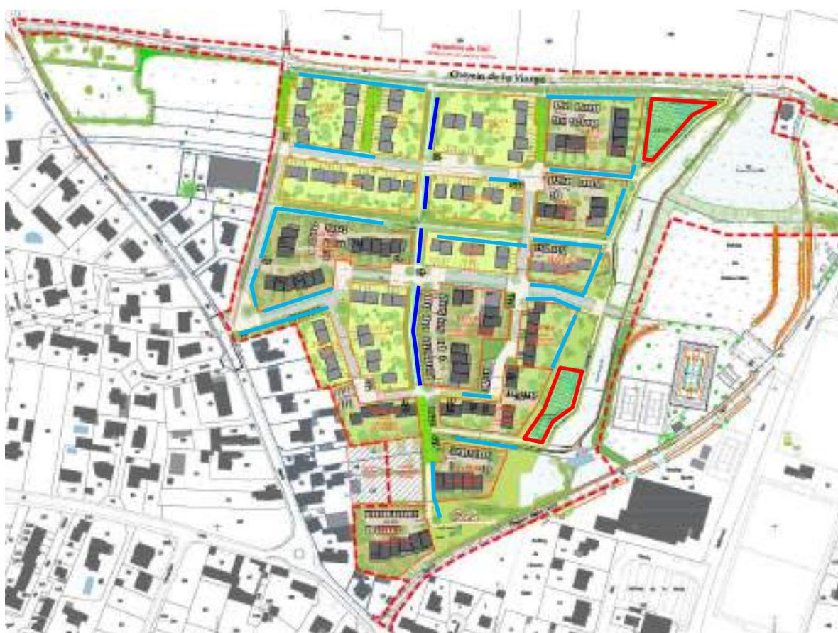
**Figure 24 : Plan simplifié de la collecte des eaux pluviales – stade Esquisse**
