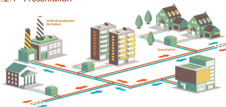
Figure 16 Schéma de principe d'un réseau de chaleur (Source : ADEME Ile-de-France)
